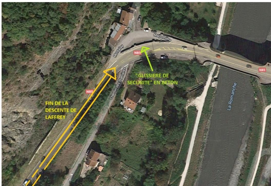
Cette solution de dernier recours permet notamment à un véhicule en perte de direction de redresser sa route pour regagner la chaussée – par un effet de rebondissement – ou de se coucher et éviter ainsi d'échouer par-delà le pont.
